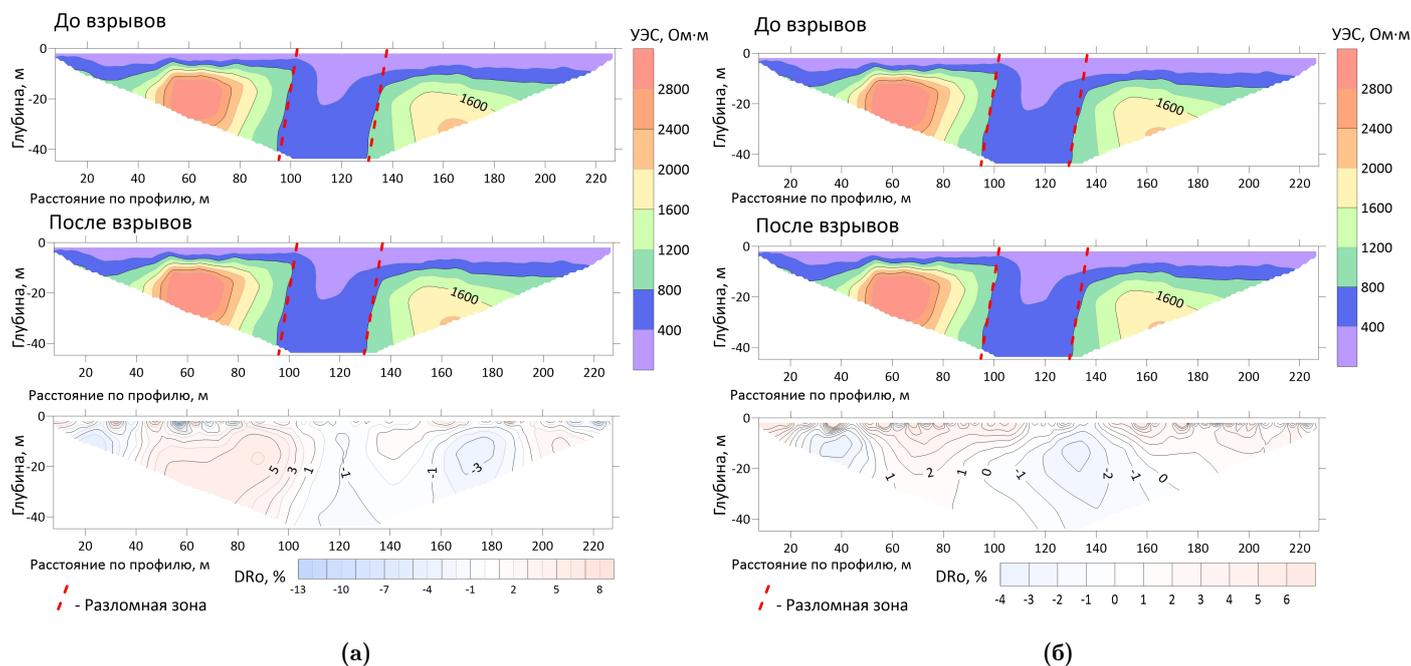
**Рис. 6.** Геоэлектрические разрезы по профилю мониторинга ЭТ и относительные изменения УЭС по всему разрезу, как реакция на взрывы; (а) – реакция на взрывы в угольных карьерах в интервале 2 и 30 августа 2023 г., (б) – реакция на взрывы в интервале 30 августа – 21 сентября 2023 г.
