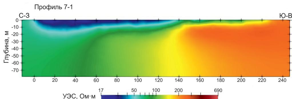
**Рис. 2.** Разрез по данным электротомографии по профилю 7 через Чемской разлом по данным электротомографии.
